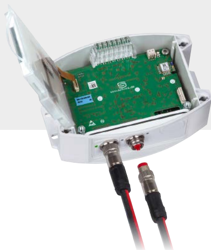
Conector M8 codificación EtherCAT P
