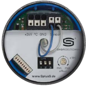
RGTM 1-U testa di collegamento
